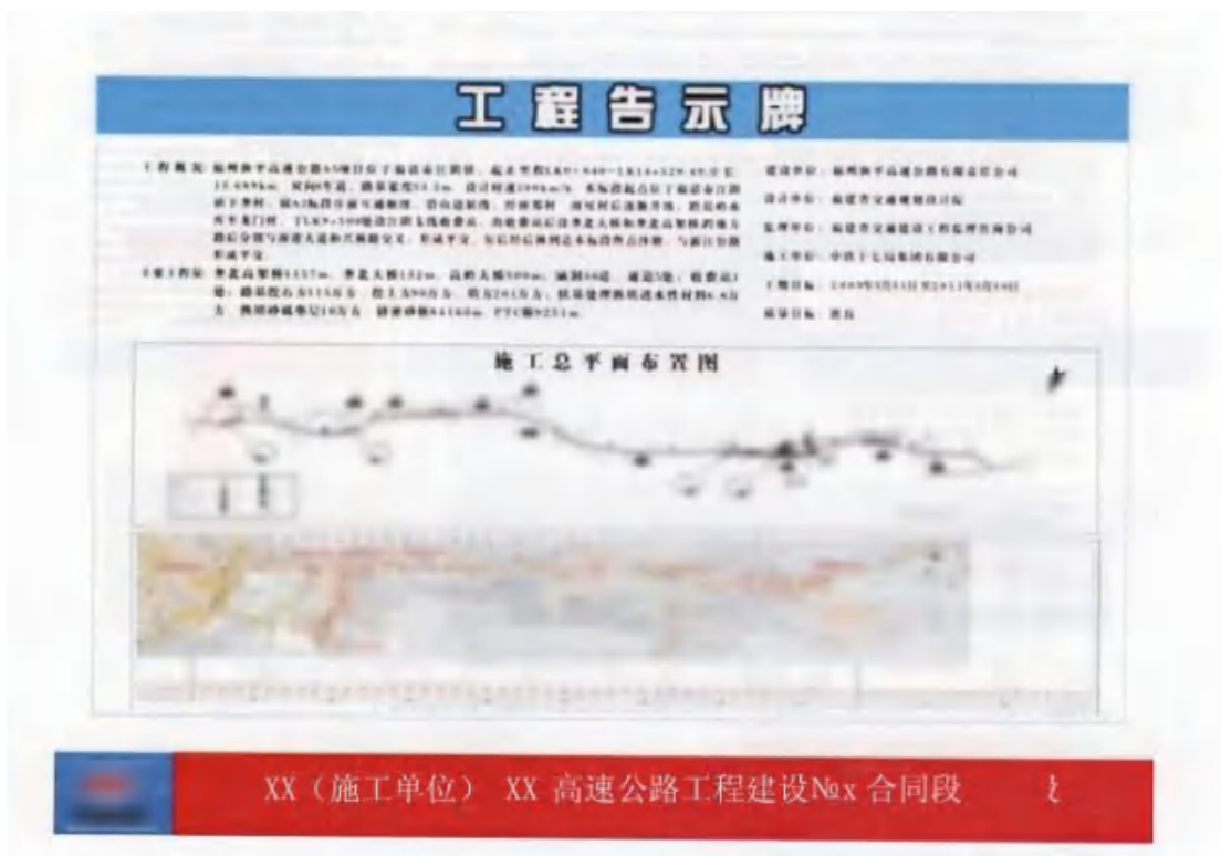
图 1-1 工程告示牌，尺寸 200 cm×120 cm，灰底黑字。
